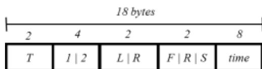
Figura 8: Pacote de dados para acionamento dos jatos de ar
