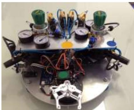
Figura 1: Robô deslizante com braço robótico de 6 graus de liberdade
