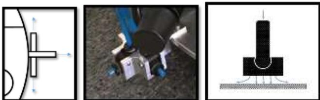
Figura 2: Bicos de jatos de ar para movimentação do robô e sapatas de sustentação
