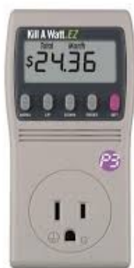
Figura 4 Monitor P4460.01 Kill a Watt E. Fonte: Própria
