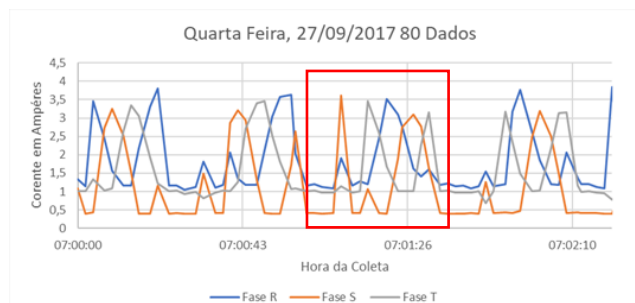
Fig. 6 – Consumo de corrente num intervalo de 2 minutos de um dia típico.
