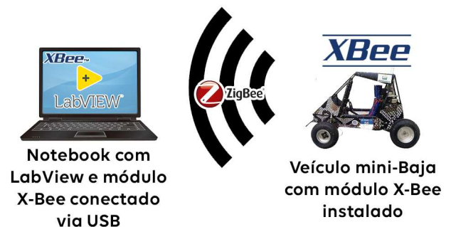
Figura 3. Esquema da comunicação veículo- box da equipe Baja UEA.
