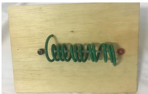
Fig. 1. Solenoide com núcleo de ar
