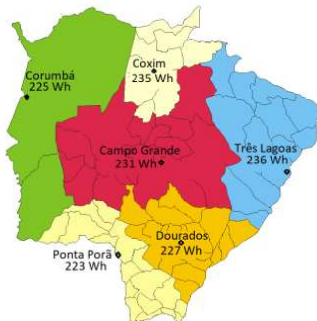
Fig. 4 – Geração Solar Fotovoltaica (Watt-hora) nas principais cidades do estado do MS para módulo CS6K-270P-FG de 270 Wp.
