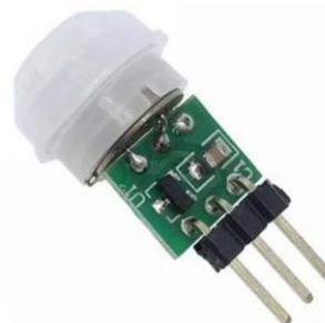
Figura 2. Sensor de Movimento PIR (infravermelho).
