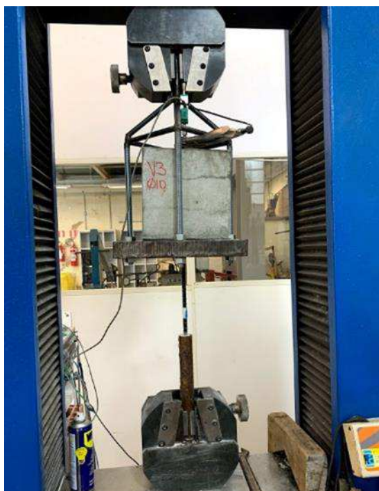
Fig. 6. Posicionamento do corpo de prova para o ensaio de arrancamento.
