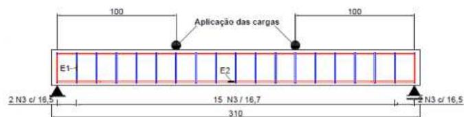
Fig. 3. Imagem da viga com ponto de aplicação de carga
