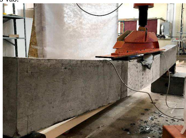
Fig. 5. Ruptura da viga armada com BFRP por esmagamento do concreto.
