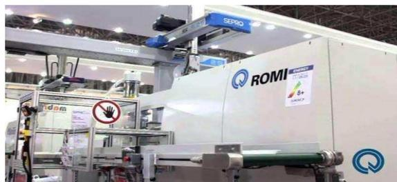
Figura 1: Máquina Injetora de Plástico
