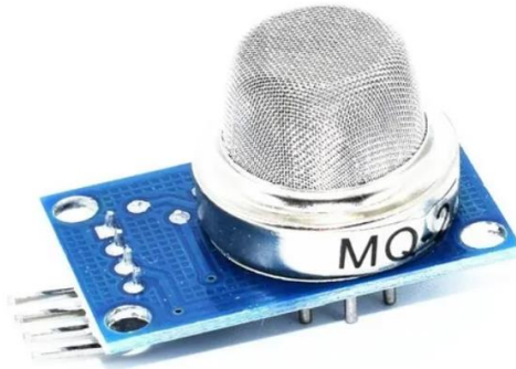
Figura 8 – Representação do sensor de gás [9]
