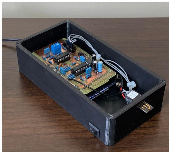
Fig. 1. Montagem do potenciostato
