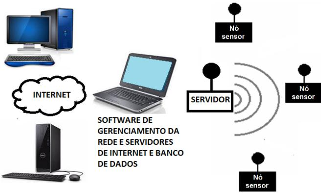
Figura 1 - Arquitetura de uma RSSF. Fonte: Adaptado de [21]
